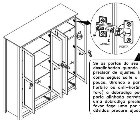
Se as portas do seu móvel ficarem desalinhadas quando fechadas elas podem precisar de ajustes. Isto pode ser feito como segue: solte o parafuso (w) um pouco. Girando o parafuso (z) no sentido horário ou anti-horário (para dentro ou fora) a dobradiça pode ser ajustada e a porta alinhada corretamente. Se mais de uma dobradiça precisar de ajuste por favor faça uma por vez. Em caso de dúvidas procure ajuda profissional.
